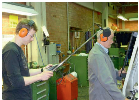
Abb. 6 Nachführen des Mikrofons mit Hilfe einer Stativstange
