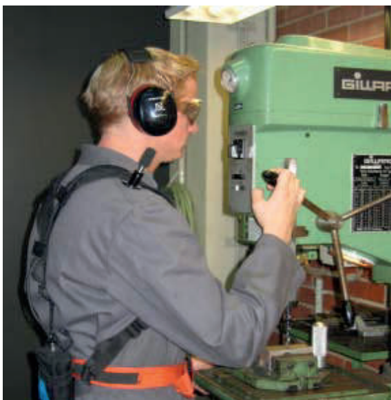
Abb. 7 Einsatz eines Schalldosimeters in Verbindung mit einem speziellen Gurtsystem zur Fixierung des Mikrofons
